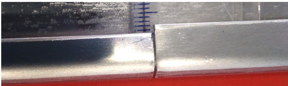
Fot 1. Wywinięcie blachy.
